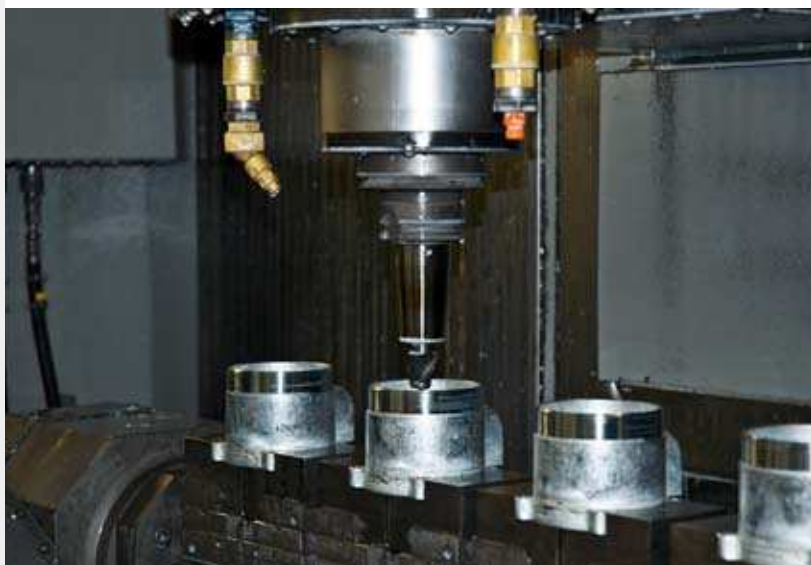
На нашем производстве. Вверху показана обработка цилиндра пневматического насоса 5:1 на обрабатывающем центре.
